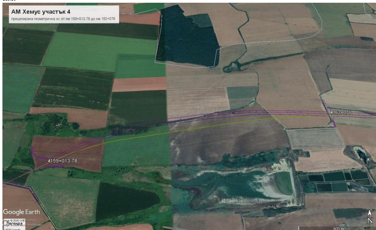
Фигура 1: Сателитно изображение на прецизираната пътна ос от км 159+013.78 до км 162+076. В зелен цвят е одобрената с Решение 2-2/2015г. следа, а в лилаво е обхвата на трасето съгласно техническия проект.
